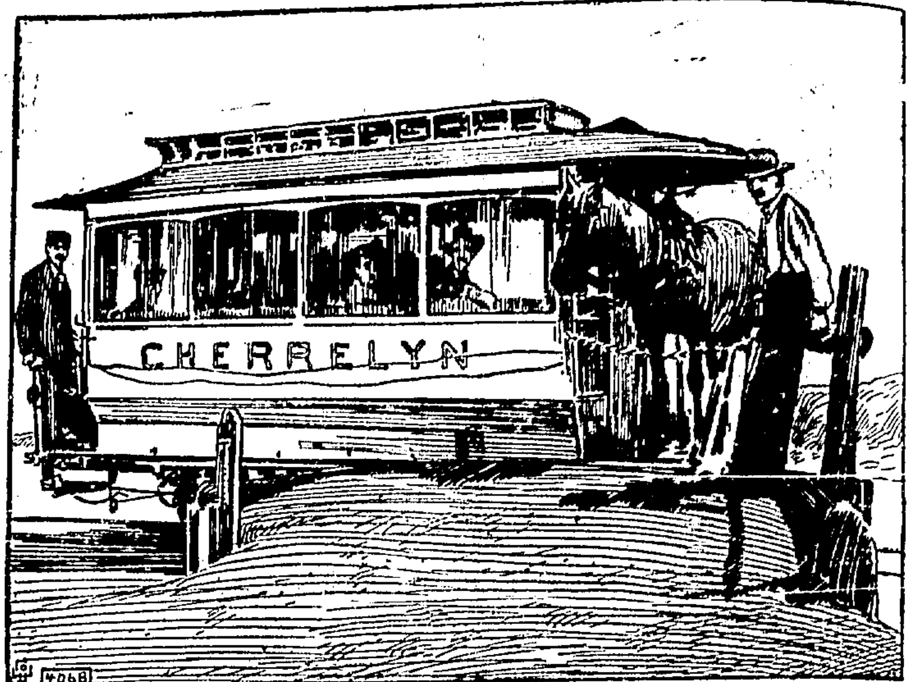
Pferde als Straßenbahnfabrikate. Eine originelle Straßenbahn besitzt Cherrelyn in der Nähe von Feuer in Colorado. Die Bahn fährt von Englewood nach Cherrelyn in der Nähe von Feuer in Colorado. Die Bahn fährt von Englewood nach Cherrelyn eine beständig aufsteigende Strecke. Die Rückfahrt bergab macht das Pferd auf dem Hinterpercon mit, während der Aufscher vorn die Bremse bedient.
